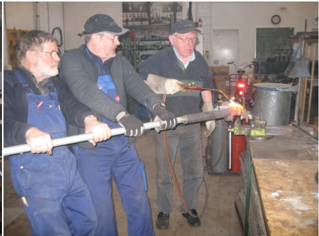
Og bukkes. Materialediameteren er 50 mm.
